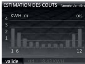
Votre thermostat mesure la quantité d'énergie utilisée par votre système de plancher chauffant. Ainsi, vous pourrez voir quelle est votre consommation d'énergie et configurer vos programmes pour déterminer à combien s'élèvent vos dépenses énergétiques.
